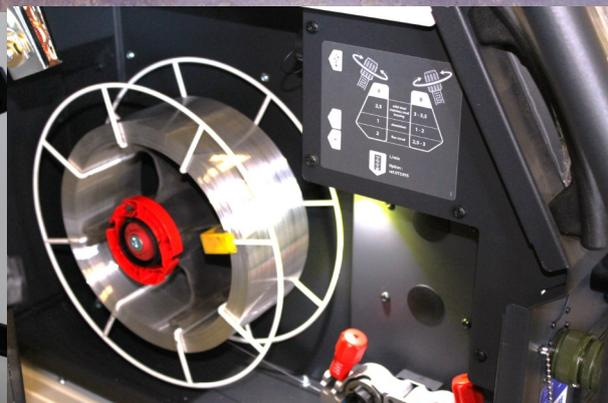
Avec vitre pour voir le contenu de la bobine, une led éclaire la bobine pendant la soudure
