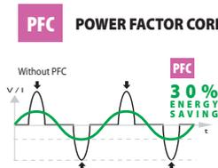
La technologie PFC supprime les pics et règle le courant d'alimentation. Favorise aussi l'utilisation de rallonges ou de groupes électrogènes et contribue à obtenir une meilleure stabilité du courant pendant la phase de soudage.
